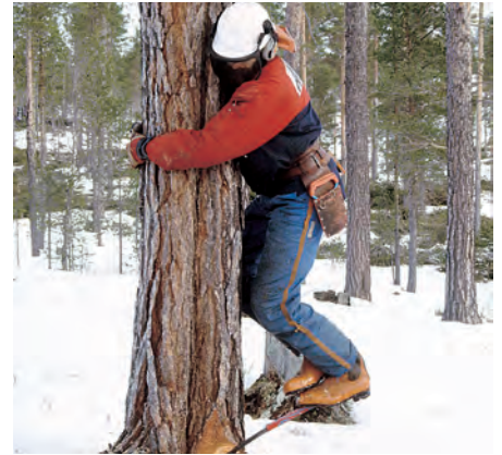
Trampejern - et ergonomisk gunstig verktøy ved felling.
