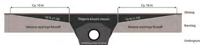
Figur 4.9 Prinsippskisse av kile over stikkrenne.
