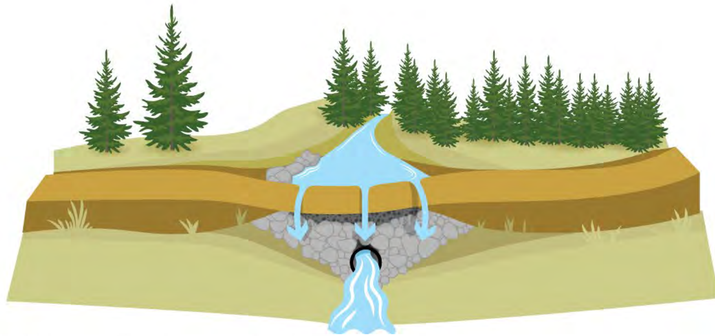
Figur 4.4 Lavbrekk over stikkrenne er et eksempel på en alternativ flomvei.
